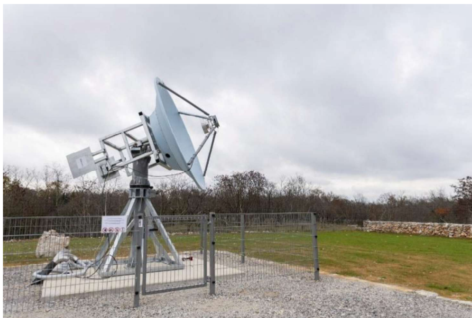
Slika 6: 2,4-metrski radijski teleskop za opazovanje emisije molekule OH v vesolju. Teleskop stoji v kraju Nova vas v občini Miren-Kostanjevica
