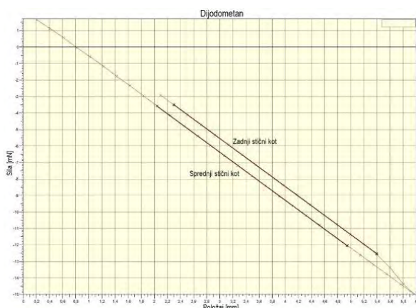
Slika 2. Sila v odvisnosti od položaja Kerrock preizkušanca med potapljanjem in vlečenjem iz dijodometana.
