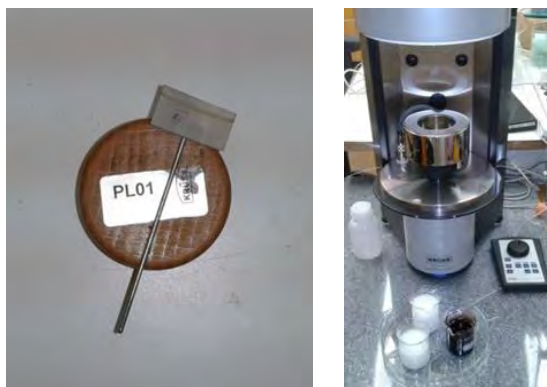
Slika 5. Platinasta ploščica za določevanje površinske napetosti tekočin (levo) in Krüss Processor Tensiometer K100 z lepilnimi smolami UF, MUF in FF (desno).
