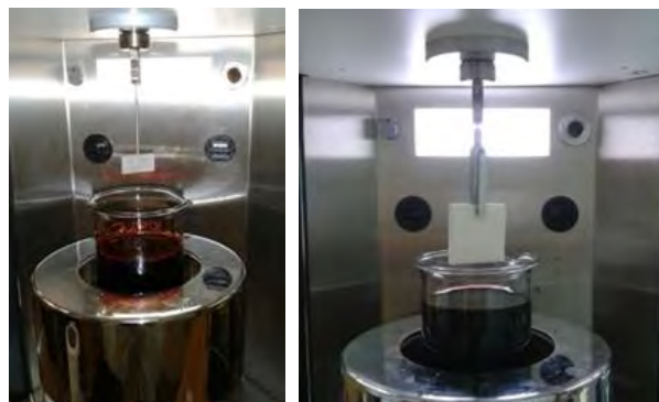
Slika 6. Merjenje površinske napetosti FF lepila z uporabo platinaste ploščice (levo) in merjenje stičnega kota med Kerrockom in FF lepilom (desno).
