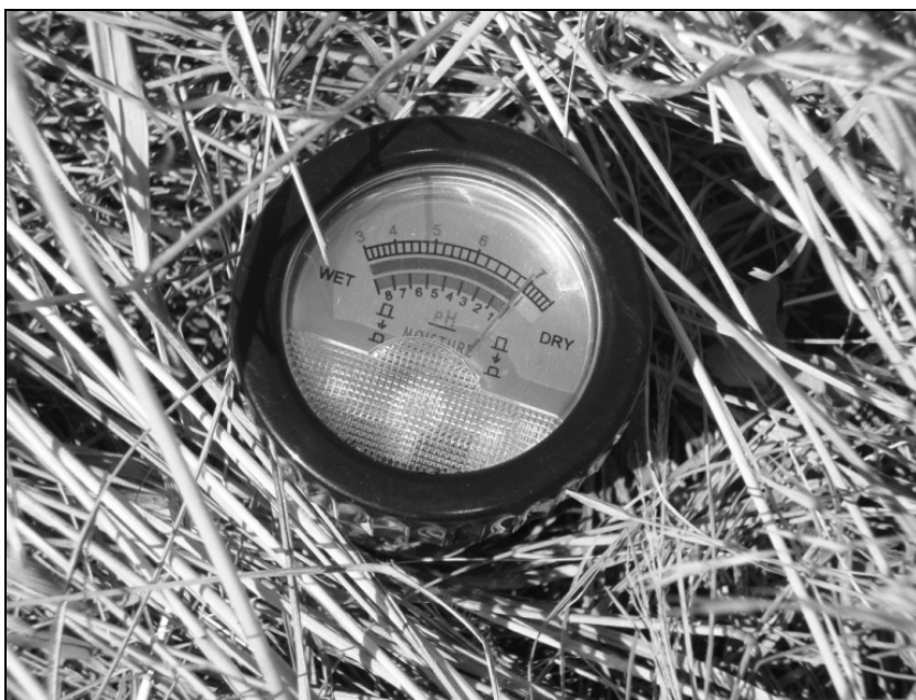
Slika 2: Aparat Soil pH moisture meter se uporablja za terenske raziskave. Merilno območje vlage ima 1 – 8 (1 je suho, brez vlage, torej 0 % in 8 je mokro, vse pore so zapolnjene z vodo, torej 100 % ). Razmik med stopnjami od 1 do 8 je 12,5 % vlage.
