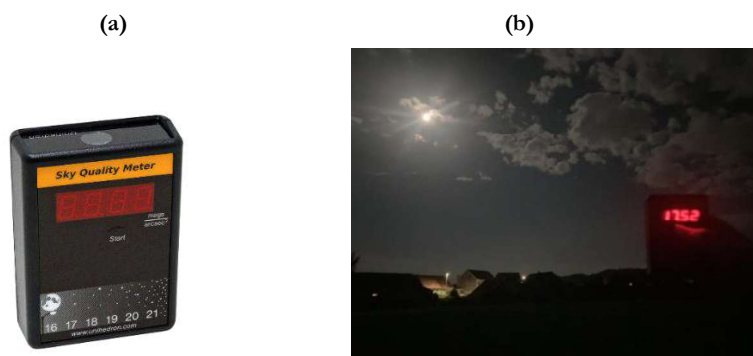
Slika 1: (a) Merilni instrument SQM-L ( Sky Quality Meter , 2021) in (b) postavitev merilnika.
